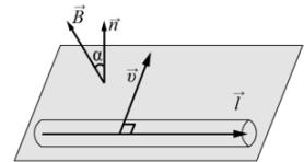
ЭДС индукции в прямом проводнике длиной  $l$ , движущемся со скоростью
